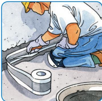
Raccordare tutti gli angoli parete / pavimento con banda coprifilo **AQUASCUD® JOIN** utilizzando **AQUASCUD®** come collante.
